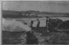
Industrie de l'iode. Les varechs sont brûlés à proximité de la côte où s'est faite la récolte.
